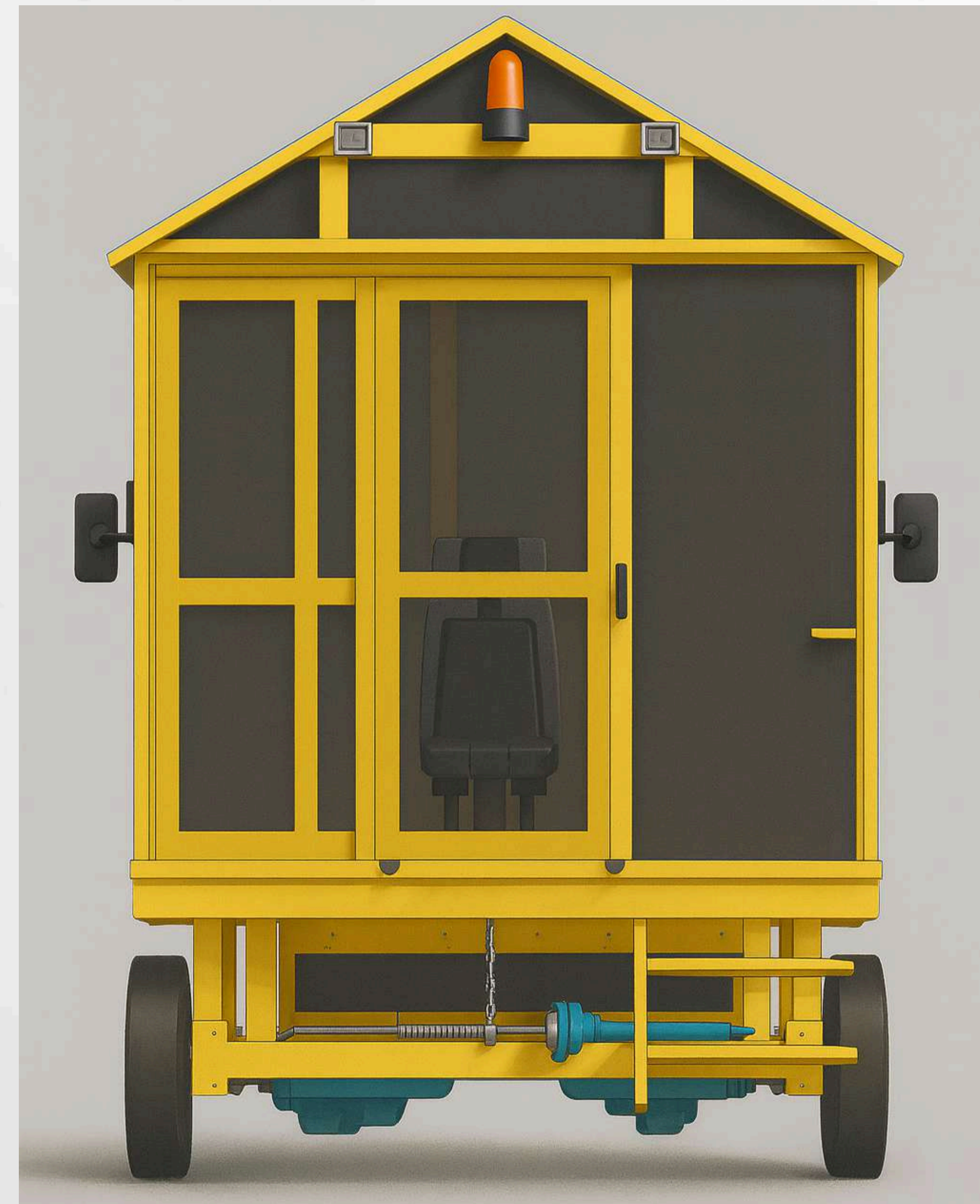
Projeto de Carro de Inspeção para fornos na área industrial de bioflorestas
