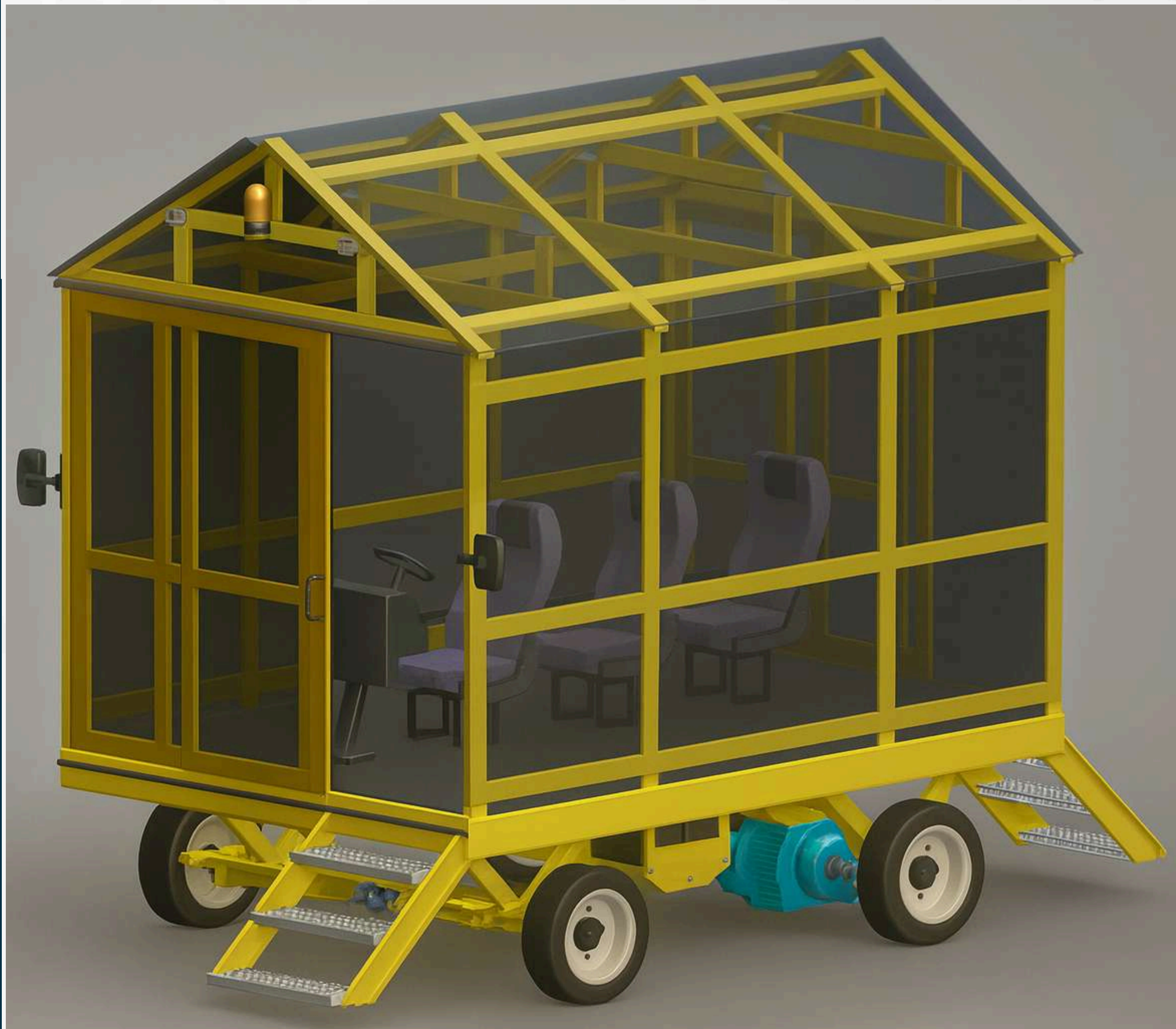
Projeto de Carro de Inspeção para fornos na área industrial de bioflorestas
